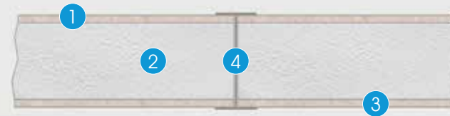
"H" Birleşim Detayı "H" Junction Detail
