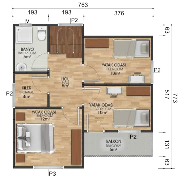
1. Kat Planı / First Floor Plan 49m 2 + 5m 2 = 54m 2
