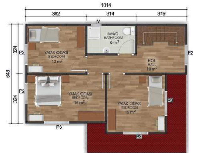
1. Kat Planı / First Floor Plan 64m 2
