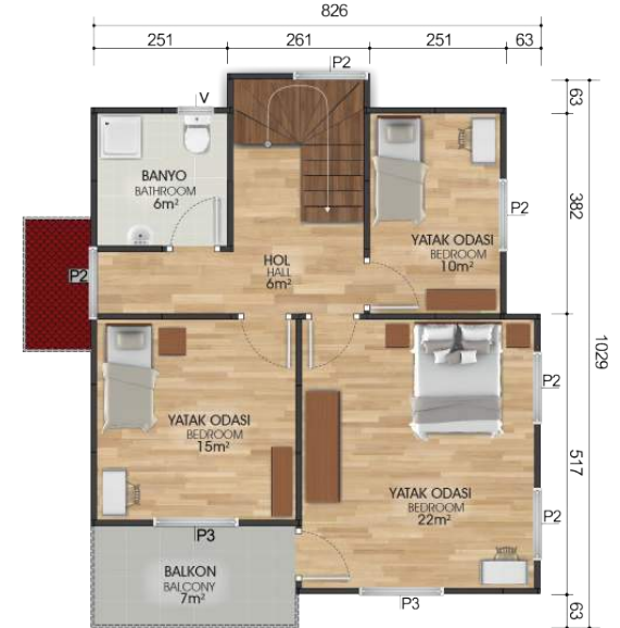
1. Kat Planı / First Floor Plan 68m 2 + 7m 2 = 75m 2
