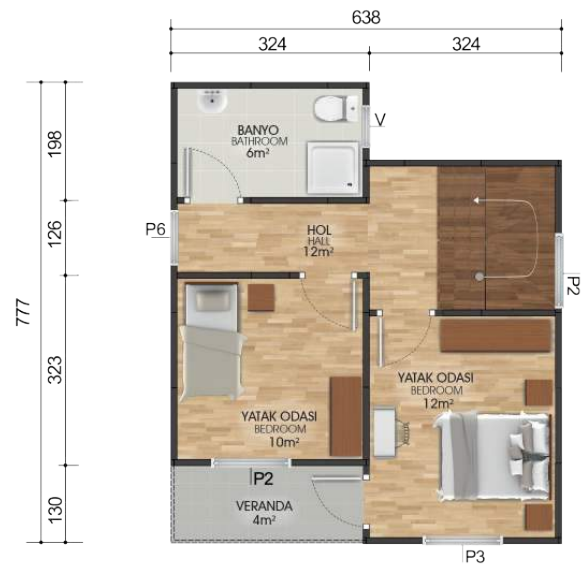
1. Kat Planı / First Floor Plan 41m 2 + 4m 2 = 45m 2
