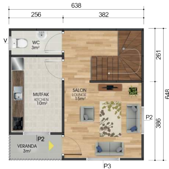
Zemin Kat Planı / Ground Floor Plan 38m 2 + 3m 2 = 41m 2
