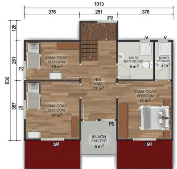
1. Kat Planı / First Floor Plan 66m 2 - 6m 2 = 72m 2
